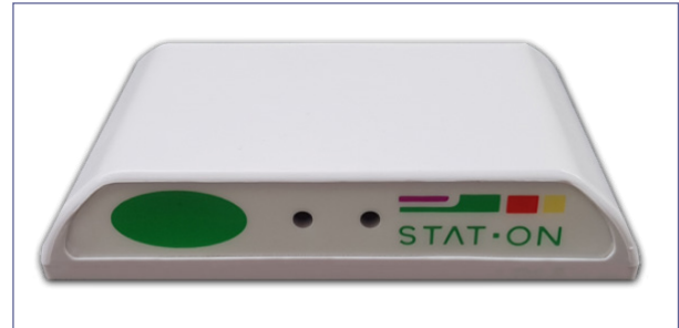
Figura 7. Sensor STAT-ON, cuyo único botón se encuentra en la parte izquierda del sensor, y sirve para marcar eventos, p.ej.: toma de medicación.
